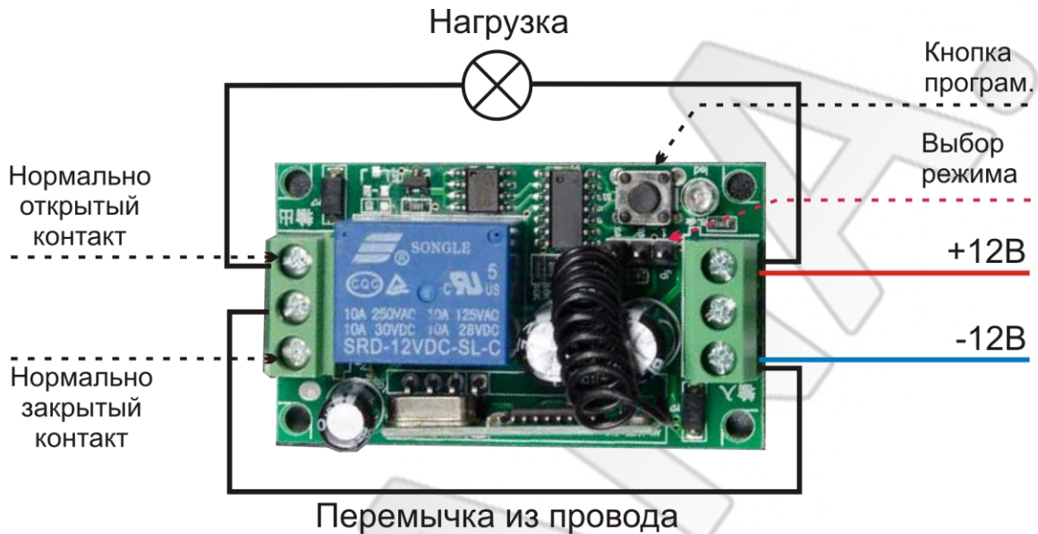
Рисунок 1 – Примерная схема подключения нагрузки
