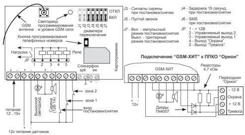
При использовании для постановки/снятия выхода «Охрана» от внешней централи, джампер J7 должен быть в положении выключено (триггерный).
