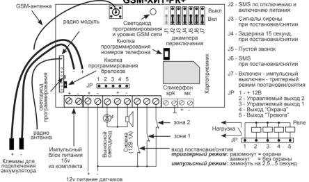
Внимание! При установленном радио модуле вход постановки/снятия не работает, а джампер J7 переключения работы входа постановки/снятия должен быть в положении выключен (триггерный).
