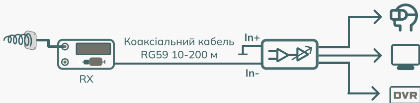
Використання підсилювача в прийомній станції в лінійному режимі, інверсне включення
