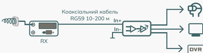
Використання підсилювача в прийомній станції в лінійному режимі
