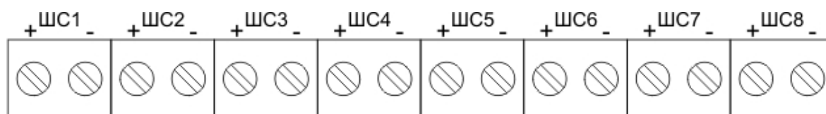
1 – винтовые клеммы ШС «ШС 1»... «ШС 8».
