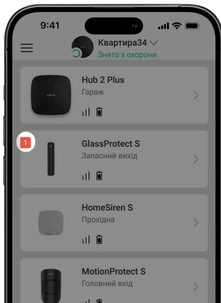
Якщо система виявляє несправність датчика, на його іконці в застосунку Ajax з'являється лічильник несправностей. Усі несправності можна переглянути у станах датчика – відповідні поля мають червоний колір.
