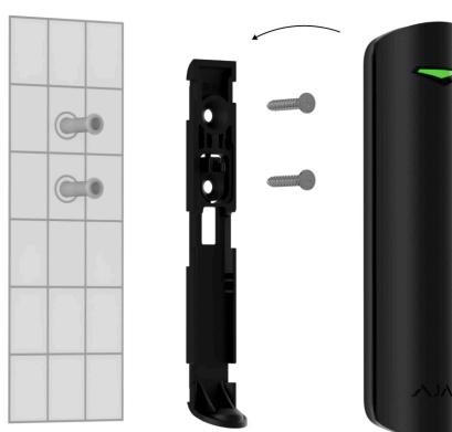
**10.** Закрутіть утримуючий гвинт на нижній частині корпусу датчика. Це потрібно, щоб надійно закріпити пристрій і захистити його від
