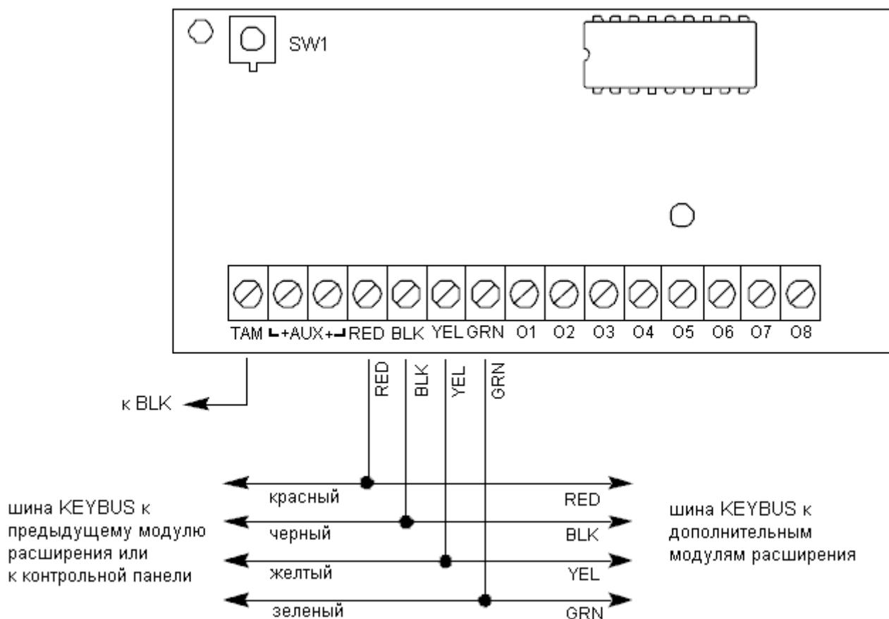
**TAM** – может использоваться для подключения контакта НСД корпуса, в котором установлен PC5208. Подключите нормально замкнутый (NC) контакт между клеммами **TAM** и **BLK**. Если НСД не используется, то во избежание состояния неисправности закоротите **TAM** и **BLK**.
