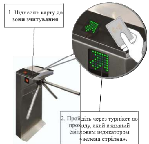
Рис.6 –Принцип роботи при використанні безконтактних карток за наявності системи контролю та управління доступом
