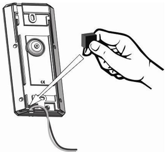
11. Установите основание детектора на кронштейн и зафиксируйте винтом.
