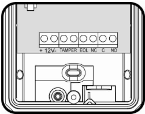
**Контакт 1 - отмеченный “+” (+12V)** – Подключить к положительному выходу источника тока 9,6 – 16В на контрольной панели.
