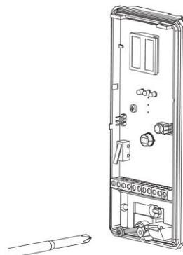
7. Снимите основание детектора с металлического кронштейна.
