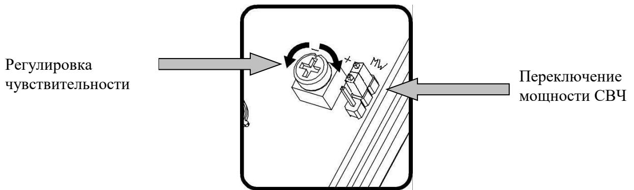
Регулировки чувствительности осуществляются потенциометром и СВЧ джампером рядом с ним (положение стрелки потенциометра ориентировано как часовые стрелки)
