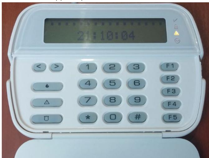
Рисунок 13. Внешний вид УИУ «Линд-11» с откинутой крышкой
