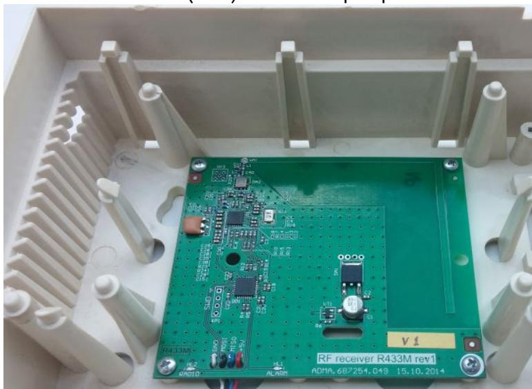
Рисунок 17. Радиоприемники серии «P433» в корпусе прибора
