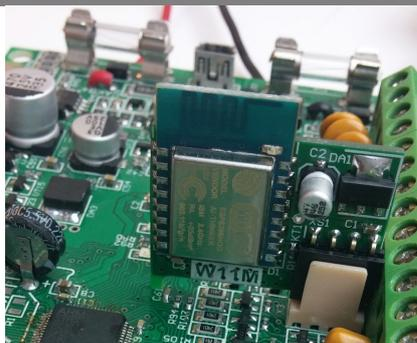
Рисунок 30. Установка модуля «W11M» в X3
