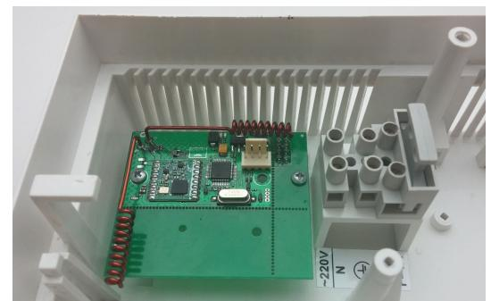
Рисунок 24. Радиоприемник Ajax «uartBridge» в корпусе прибора
