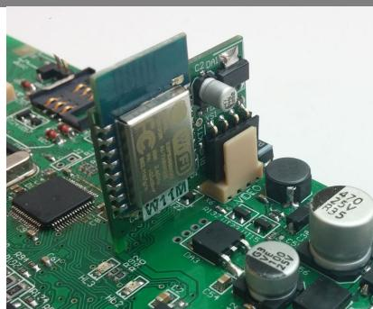
Рисунок 31. Установка модуля «W11M» в X6
