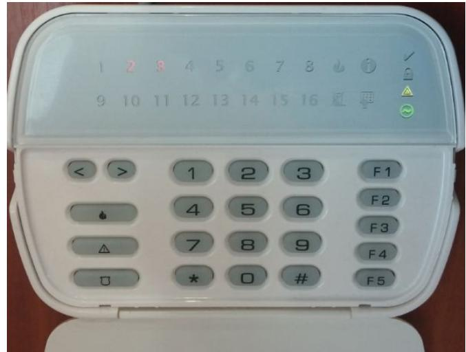
Рисунок 14. Внешний вид УИУ «Линд-11LED» с откинутой крышкой
