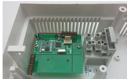
Рисунок 24. Радиоприемник Ajax «uartBridge» в корпусе прибора
