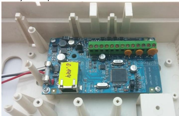
Рисунок 25. Коммуникатор «LanCom» rev.15 в корпусе прибора
