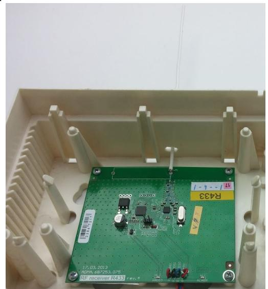
Рисунок 18. Радиоприемник «P433» rev.4 с антенной в корпусе прибора
