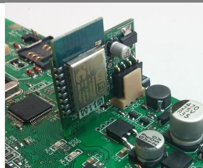
Рисунок 31. Установка модуля «W11M» в X6
