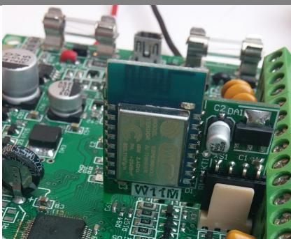
Рисунок 30. Установка модуля «W11M» в X3
