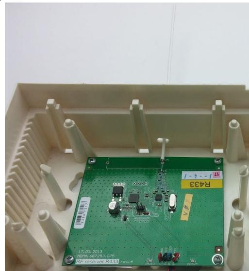
Рисунок 18. Радиоприемник «P433» rev.4 с антенной в корпусе прибора
