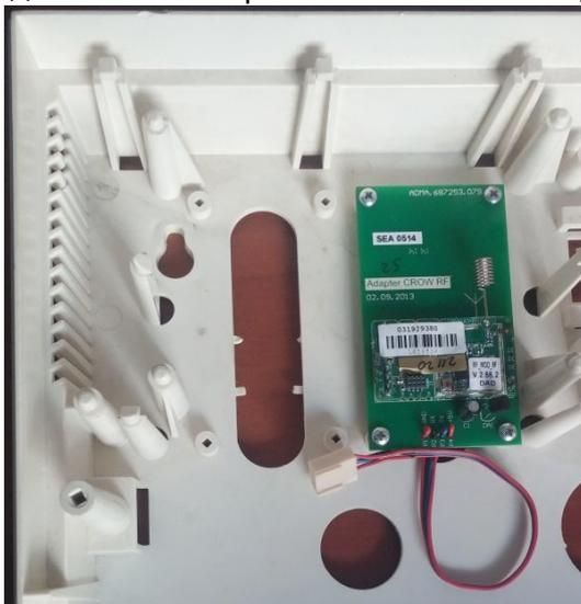
Рисунок 22. Радиомодуль «Адаптер Crow – Лунь-11» в корпусе прибора
