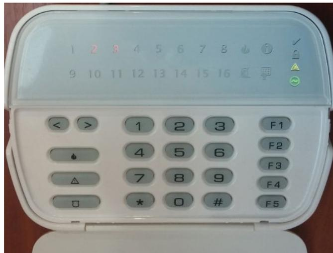
Рисунок 14. Внешний вид УИУ «Линд-11LED» с откинутой крышкой
