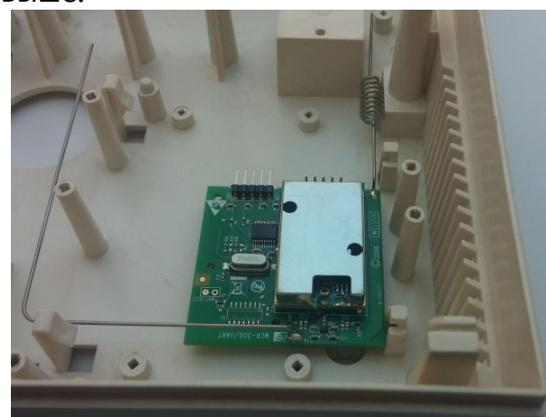
Рисунок 20. Радиоприемник «MCR-300» Visonic в корпусе прибора
