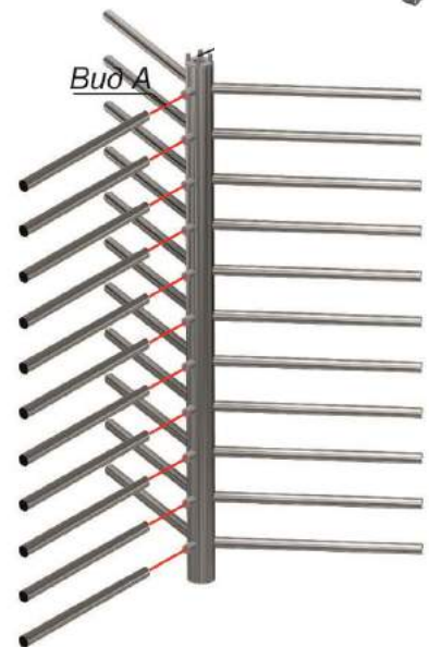
Рис.10– Сборка основных элементов и установка поводков турникета
