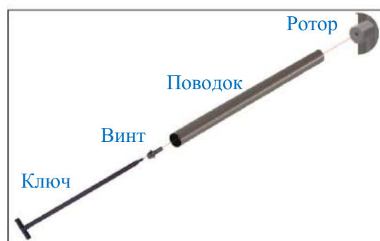
Рис.11– Сборка основных элементов и установка поводков турникета
