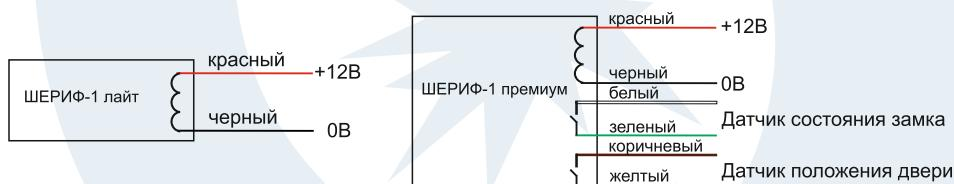
Схема подключения замка "Шериф-1 лайт" к контроллеру
