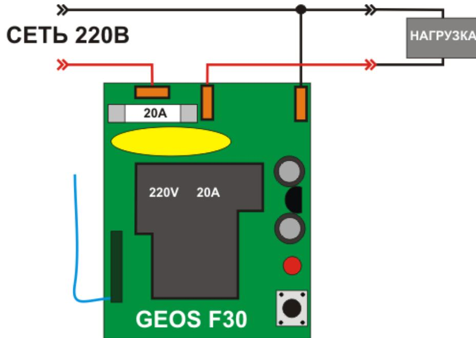
Рис 3. Подключение устройства
