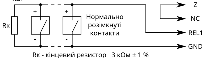
Рисунок 2.9 – Схема підключення двопровідних сповіщувачів з нормально розімкнутими контактами
