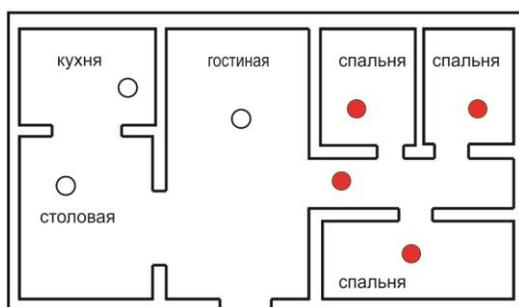
Рис.7 Пример установки сигнализаторов
