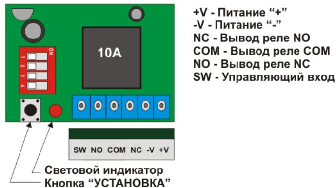
Рис. 1. Схема подключения
