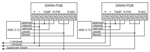
Назначение проводов модуля AMD 3-15:
