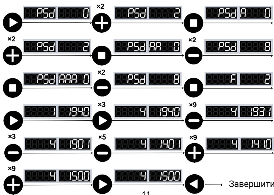
**Приклад. Налаштування частоти з 2 до 1**
