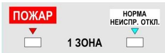
Позонные индикаторы «ПОЖАР» светятся, когда принят сигнал «ПОЖАР» от извещателя в соответствующей индикатору зоне.
