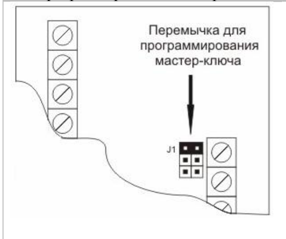
Рис. 4.2.1.1. Расположение переключателя для программирования мастер-ключа
