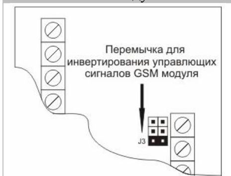
Рис. 4.2.7.1. Переключатель для инвертирования управляющих сигналов GSM модуля
