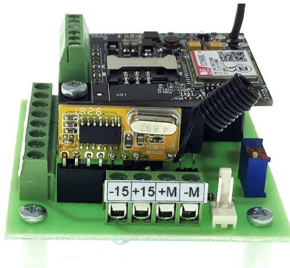
Для добавления брелков необходимо нажать кнопку программирования после погасания светодиода нажать любую кнопку на брелке. Светодиод программирования помигает и засветится постоянно – данный брелок записан в память. Если брелков несколько, то процедуру привязки повторяем.
