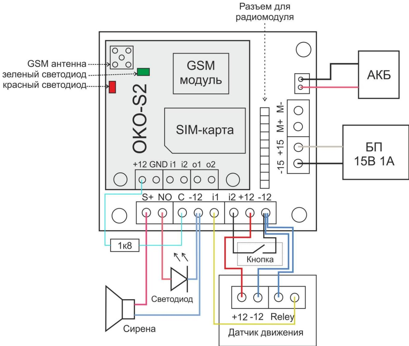
**- 15, +15** Подключение внешнего питания (блока питания) 10-15В не менее 1А. Внимание, при использовании резервного аккумулятора, подключенного к ком. плате «Switch-S2», напряжение на входе должно быть в пределах 14-15В для обеспечения полного заряда аккумулятора.
