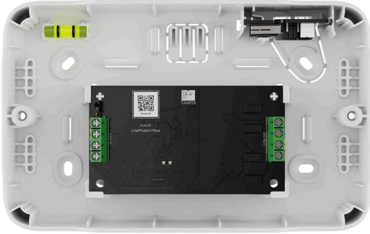
Рекомендуємо встановлювати LineProtect у корпус Case, який продається окремо і доступний у кількох версіях. У корпус Case можна помістити як один модуль, так і кілька модулів чи інших пристрій поруч.
