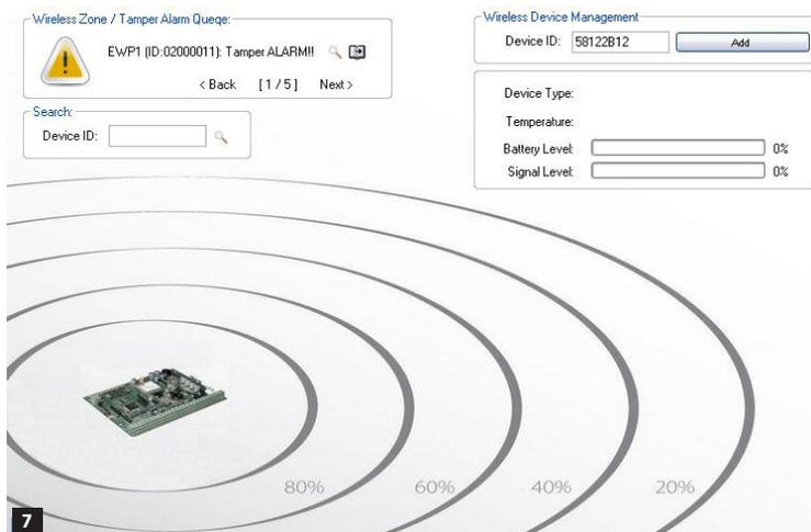
6. При удачной привязке EWS2, пункты **Уров. батареи** и **Уров. сигнала** будут видны в разделе **РЧ устройства** в программном обеспечении. При неудачной привязке, переместите EWS2 ближе к охранной панели и повторите попытку.
