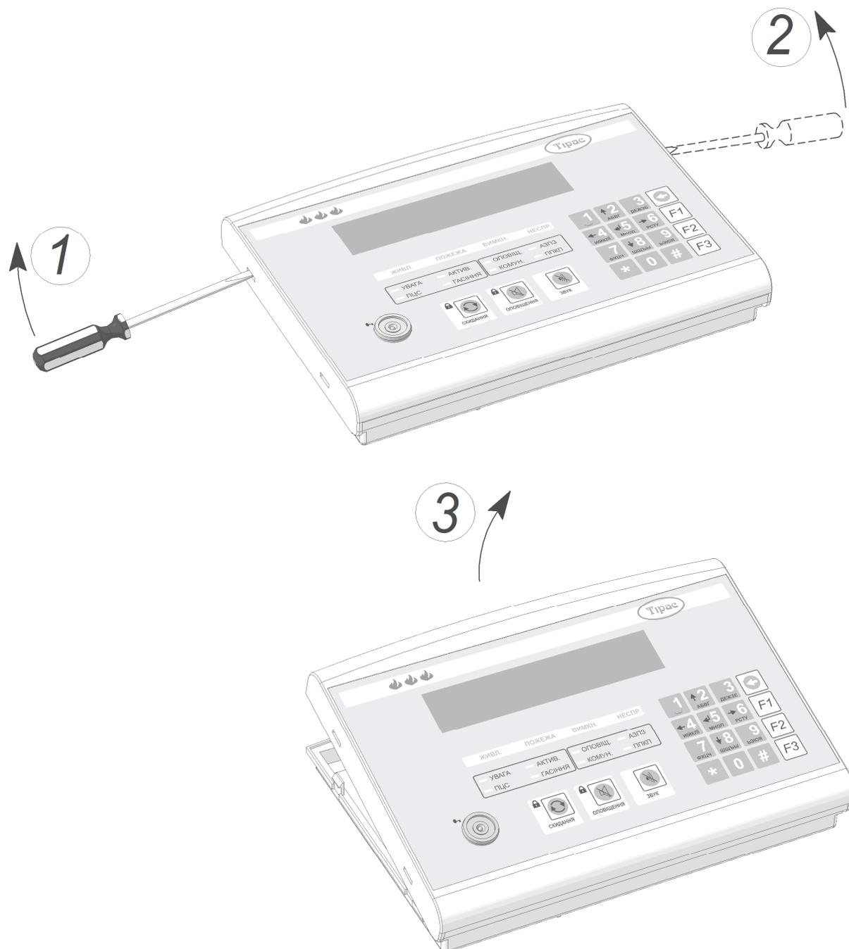
Рисунок 5.2 - Порядок открывания корпуса прибора
