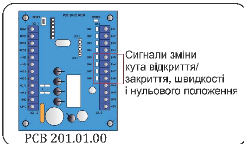
Рис. 19 – Сигнали зміни кута повороту на контролері PCB 201
