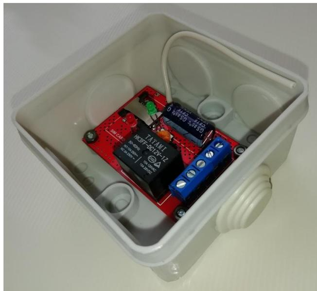
При использовании устройства для замены домофона нет необходимости в прокладывании дорогостоящих проводов.
