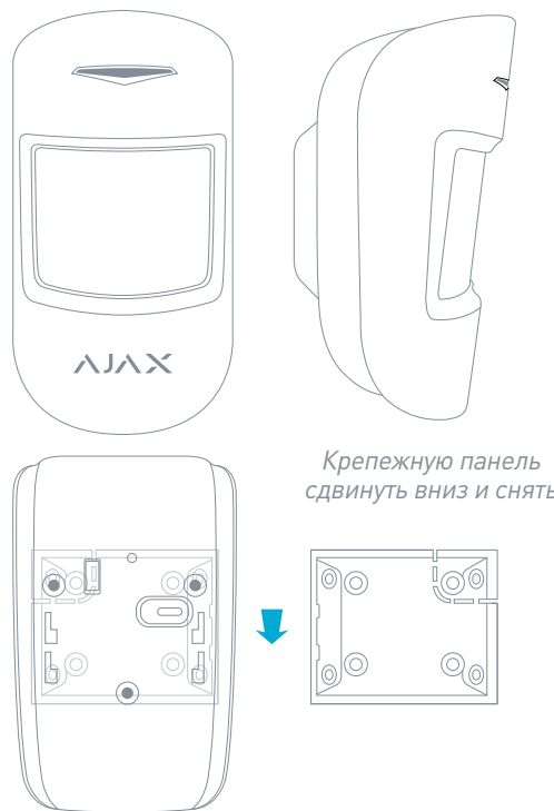
РИС. 1. Датчик движения MotionProtect и его крепежная панель
