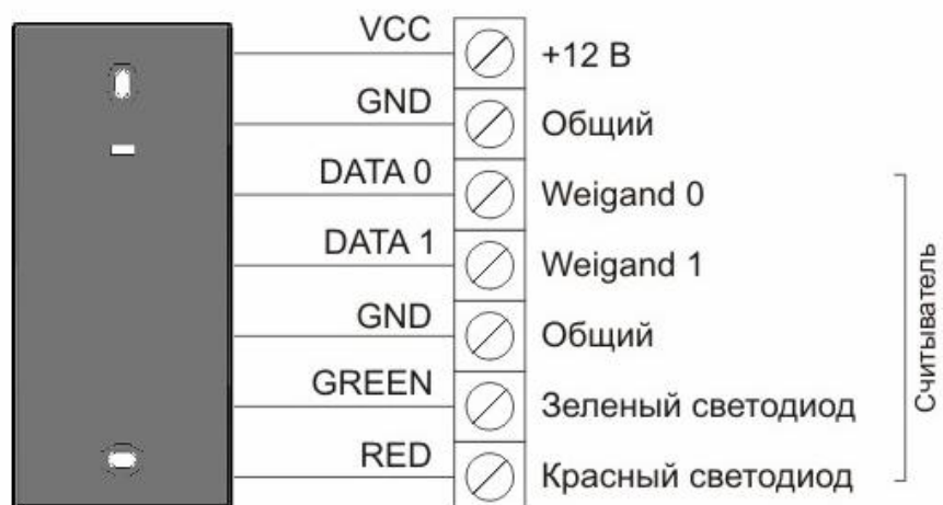
Рис. 2 Подключение по интерфейсу Weigand 26-bit
