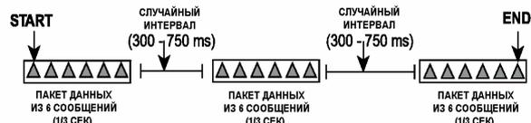
Рисунок А-2. Последовательность для Защиты от Наложений
